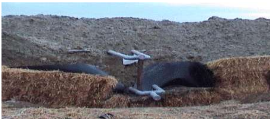
Rys. 1.16. Aktywne napowietrzanie gruntu
