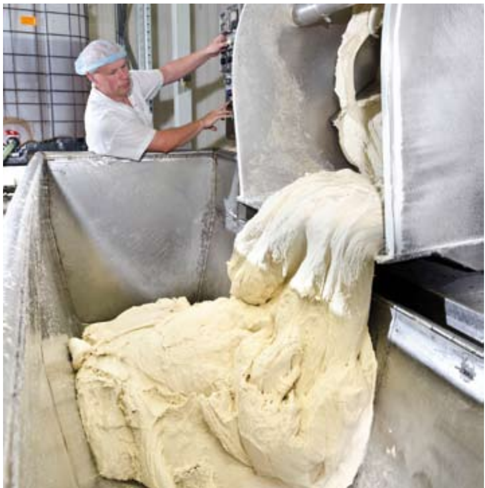
Ciastowy transportuje podmłodę w wyznaczone, ciepłe miejsce, gdzie przez trzy godziny trwa proces fermentacji. Fot. PRESSMAC
