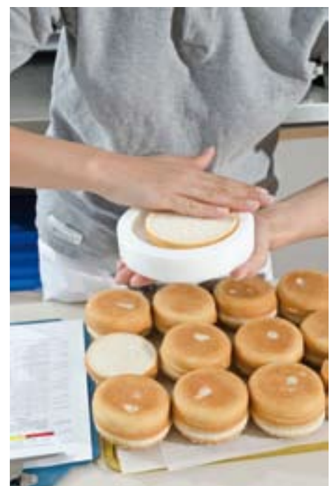
Do obowiązków działu kontroli jakości należy też pobieranie co godzinę z linii produkcyjnej piekarni pewnej ilości gotowych, wypieczonych bułek i testowanie ich pod kątem wszelkich parametrów jakościowych. Fot. PRESSMAC
