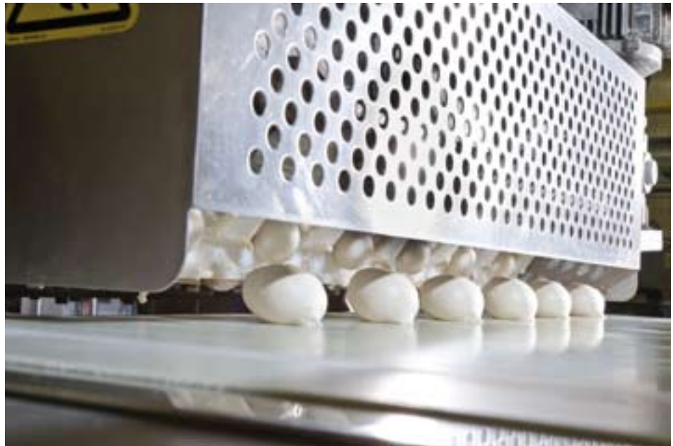
Bezpośrednio z miksera ciasto trafia do urządzenia dzielącego je na kęsy, czyli małe, kuliste kawałeczki, z których powstaną później bułki. Fot. PRESSMAC
