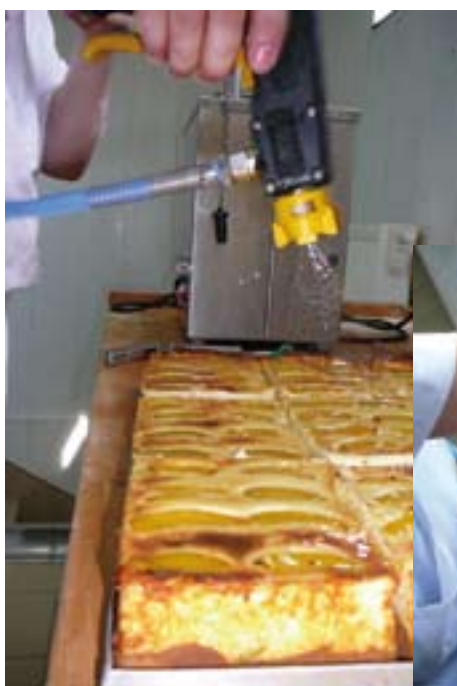
Wśród najmniejszych żelownic holenderskiej firmy Willemse & van Engelem, przeznaczonych dla niewielkich zakładów rzemieślniczych najpopularniejszym jest stołowe urządzenie Jelly-Boy. FOT. MATERIAŁY PRODUCENTA
