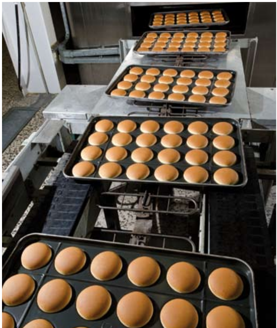
Tace po opuszczeniu pieca są przenoszone do pomieszczenia, w którym stygną. Aby zachowały swoją pulchność, chłodzenie nie może być zbyt gwałtowne - trwa dokładnie 35 minut. FOT. PRESSMAC
