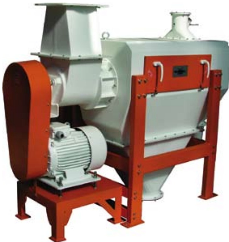
Przesiewacz cylindryczny PPCM 4008 można stosować nie tylko do mąki, ale także innych sproszkowanych, ziarnistych lub zbrylonych materiałów. FOT. SPOMASZ
