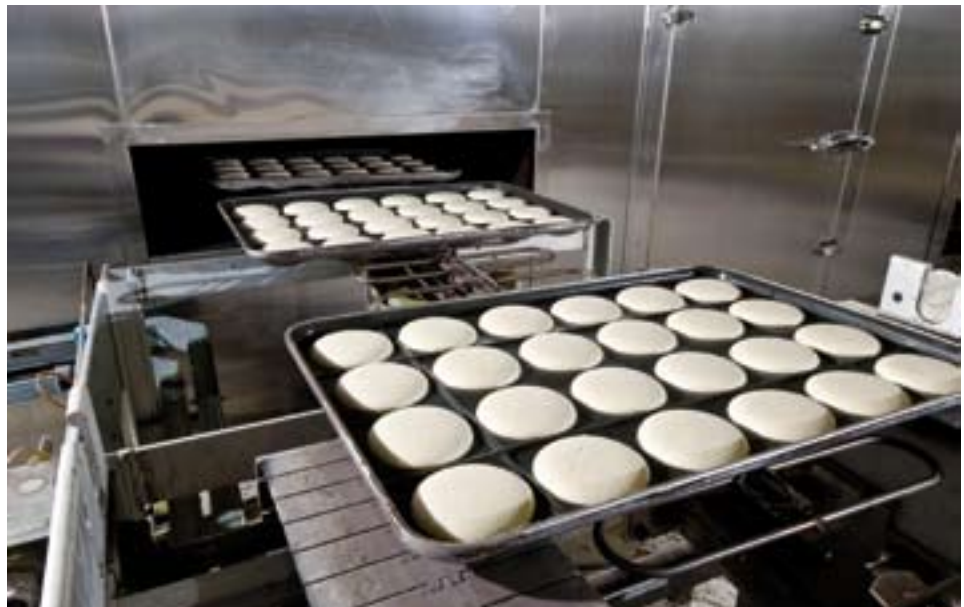
Zanim bułki znajdą się w piecu, na prawie godzinę trafiają do „garowni”. FOT. PRESSMAC
