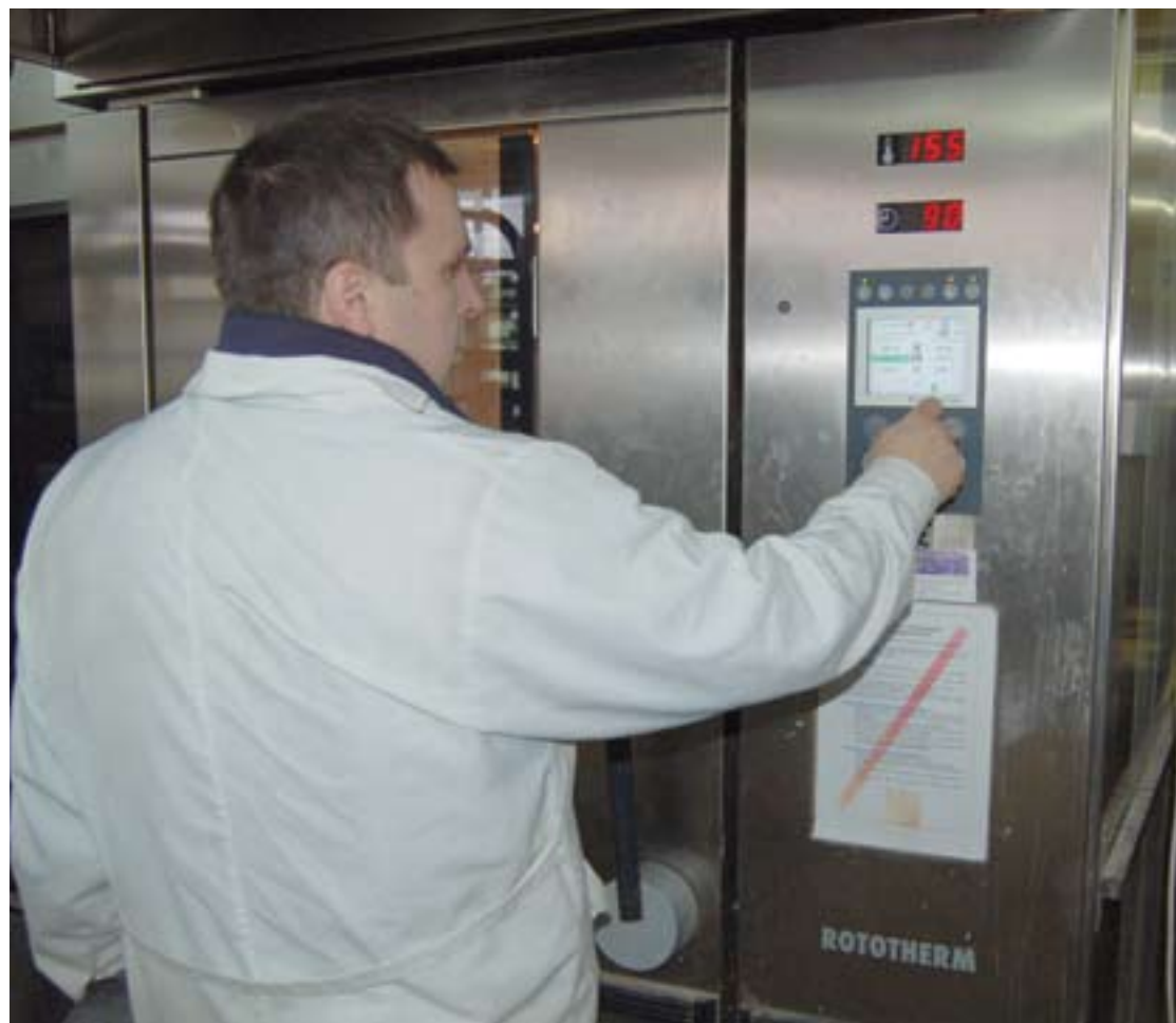
Kierownik piekarni Bogusław Galiński ustawia program sterowania Navigo, w który wyposażony jest piec obrotowy Rototherm RE 1020. Fot. B&S
