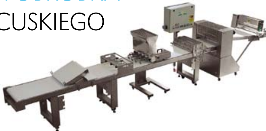
Czujniki umieszczone między kalibratorem a stołem obrabiającym ciastka francuskie i drożdżówki m. in. kontrolują napięcie ciasta i nadzorują jego delikatny transport. FOT. ALBA
