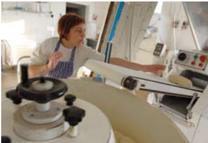
Uformowane kęsy ciasta są ręcznie odbierane i układane na blachach, które trafiają do mroźni. Fot. B&S
