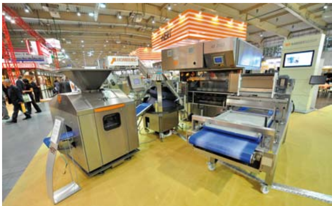
W skład linii typu Crustica wchodzi cztery maszyny: dzielarka serii V, zaokrąglarka CR 59, międzygarownia statyczna oraz wydłużarka. Fot. HERT
