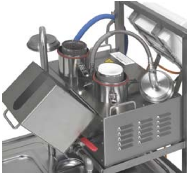
Mobilne urządzenie filtrujące FK-20 ma 2-litrowy filtr wstępny, który zatrzymuje zanieczyszczenia wielkości 1 mm oraz filtr właściwy o rozmiarze szczelin poniżej 20 \mu m. FOT. HAGESANA
