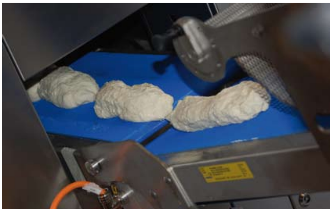
W dzielarce V300 zastosowano oryginalne rozwiązanie jakim jest Voluminator, który pozwala regulować ciśnienie na głównym tłoku, a przez to delikatnie dzielić nawet bardzo luźne ciasto. FOT. HERT
