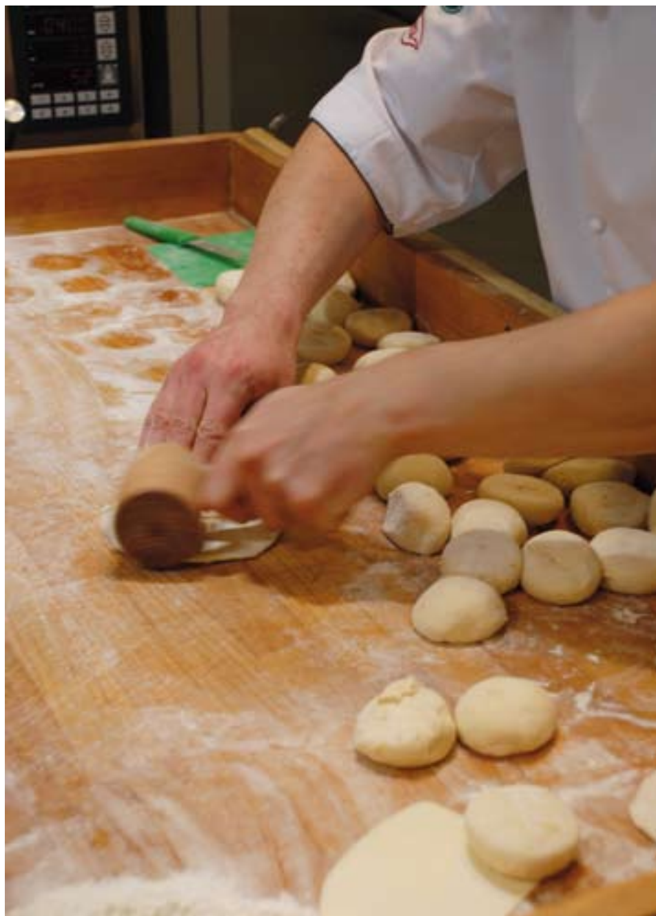
Blaty drewniane, podobnie jak blaty ze stali nierdzewnej, zabezpieczone są 4- lub 5-centymetrowymi krawędziami, które zapobiegają zsunięciu się ciasta. Fot. B&S
