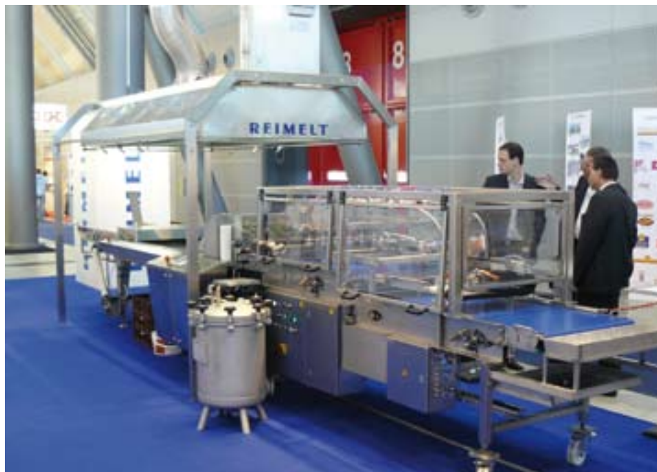
Automatyczny smażalnik olejowy Reimelt typu EL przeznaczony jest do produkcji pączków o średnicy nie większej niż 10 cm.
