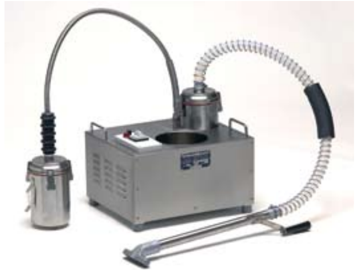
Filtr King F 20 o wydajności pompy 1200 l/h zalecany jest do pracy ze smaźalnikami do maksymalnie 100 kg tłuszczu.
