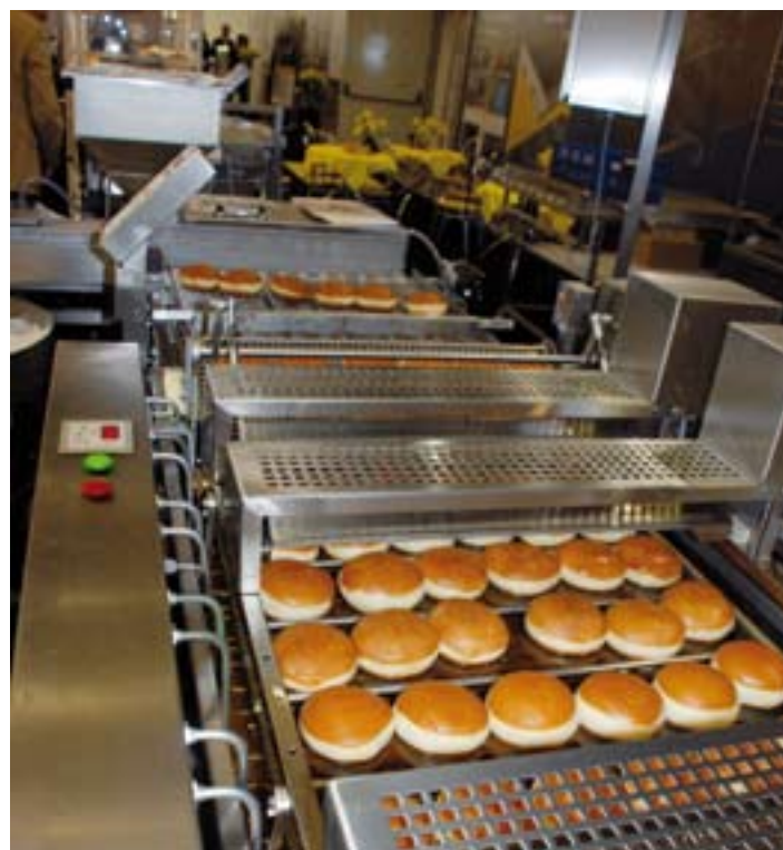
Smażalnik przelotowy Jufeba wyposażony jest w trzy stacje odwracające, które delikatnie i bezpiecznie zmieniają położenie pączków w tłuszczu. Fot. B&S
