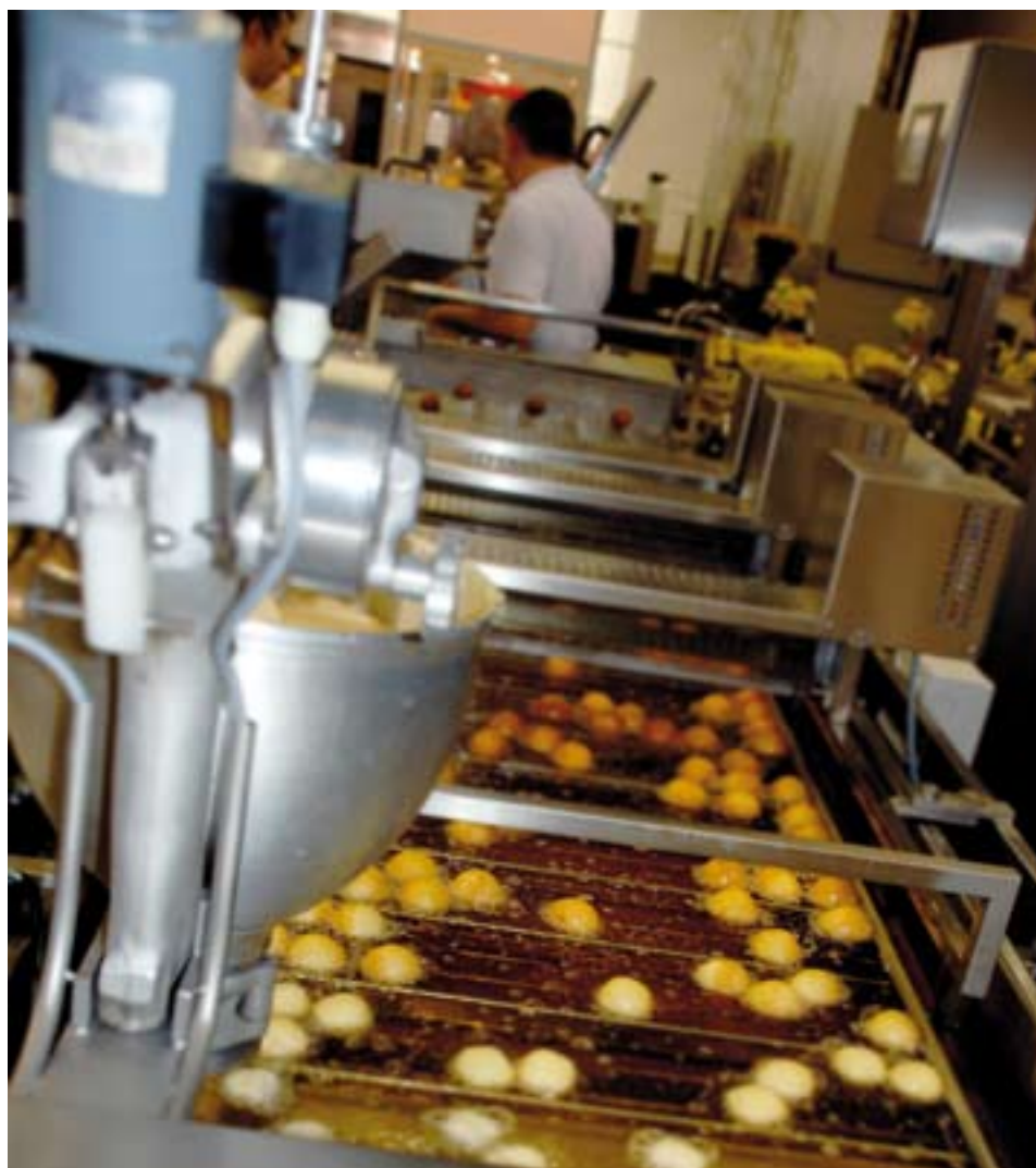
Linia przelotowa Jufeba może być dodatkowo wyposażona w urządzenie, które dozuje ciasto np. w kształcie małych kulek, w dwóch różnych wielkościach.
