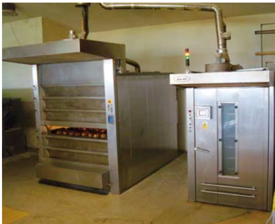
Piec termoolejowy pokładowy pod załadunek obok pieca wózkowego termoolejowego - ogrzewane tym samym kotłem z termoolejem usytuowanym poza częścią produkcyjną piekarni. FOT. IBIS
