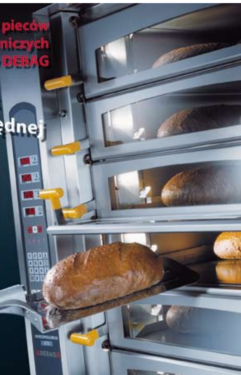
Piec termoolejowy pokładowy pod załadunek obok pieca wózkowego termoolejowego - ogrzewane tym samym kotłem z termoolejem usytuowanym poza częścią produkcyjną piekarni. FOT. IBIS
