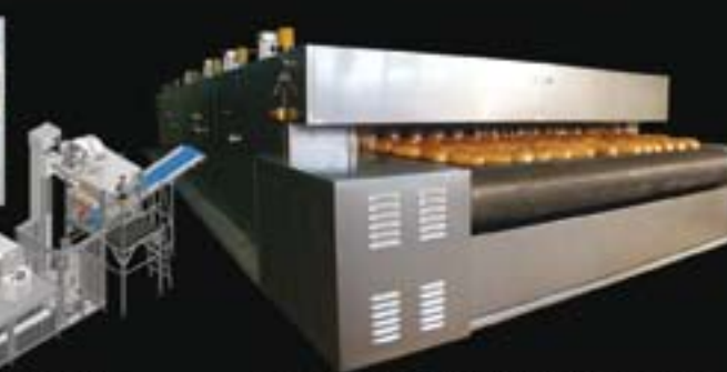
Piec termoolejowy taśmowy przelotowy
