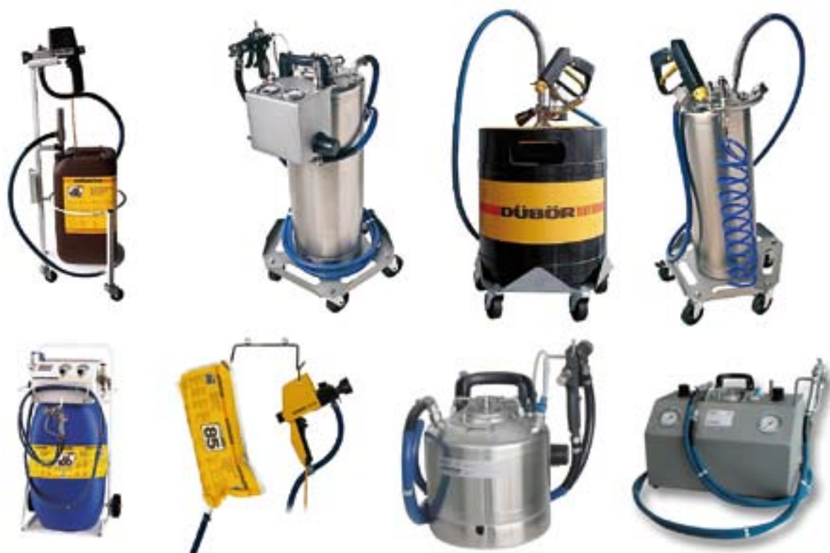
Różnorodność pistoletów natryskujących wysoko- i niskociśnieniowych, elektrycznych i pneumatycznych pozwala na profesjonalne natłuszczenie w piekarniach i cukierniach o różnej wielkości produkcji.
