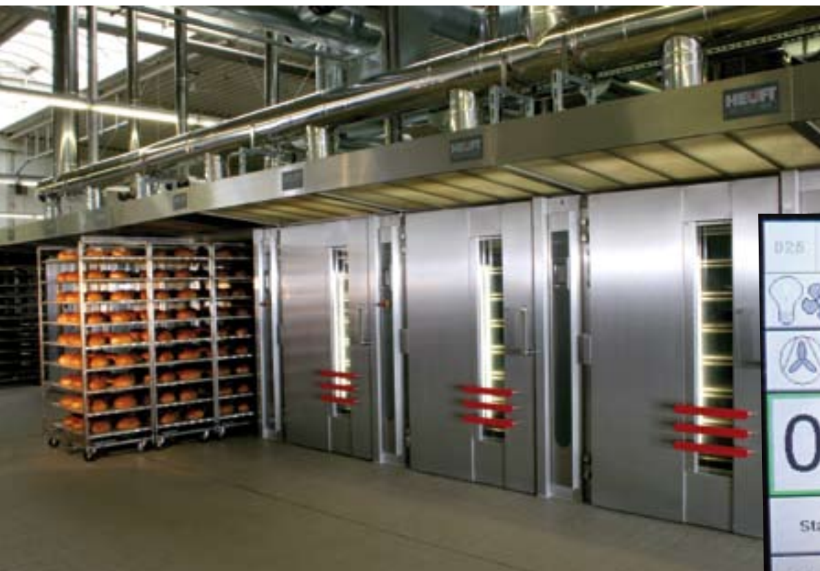
Zdalne nadzorowanie pieców Heuft możliwe jest przy zastosowaniu w tych urządzeniach sterowania komputerowego SPS HEUFT typu „Touch-Screen” i połączeniu go z przemysłowym routerem typu ZR-200A. FOT. MATERIAŁY PRODUCENTA
