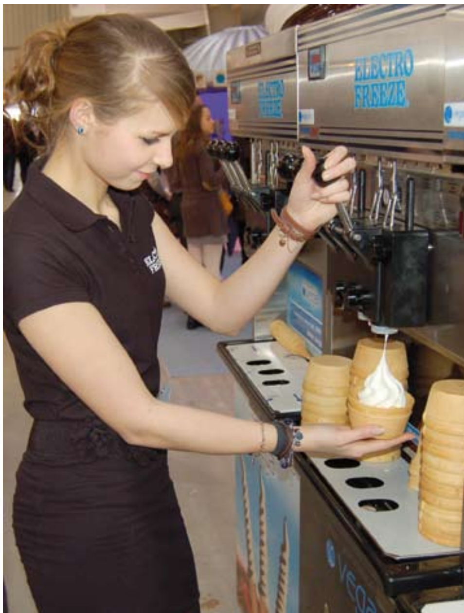
W nowym Electro Freeze 99T-RMT do lodów twardych, soft i jogurtów mrożonych można wybrać jeden produkt na obu stronach w dwóch smakach lub serwować dwa różne produkty po jednym smaku. FOT. MATERIAŁY PRODUCENTA
