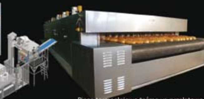
Piec termoolejowy taśmowy przelotowy
