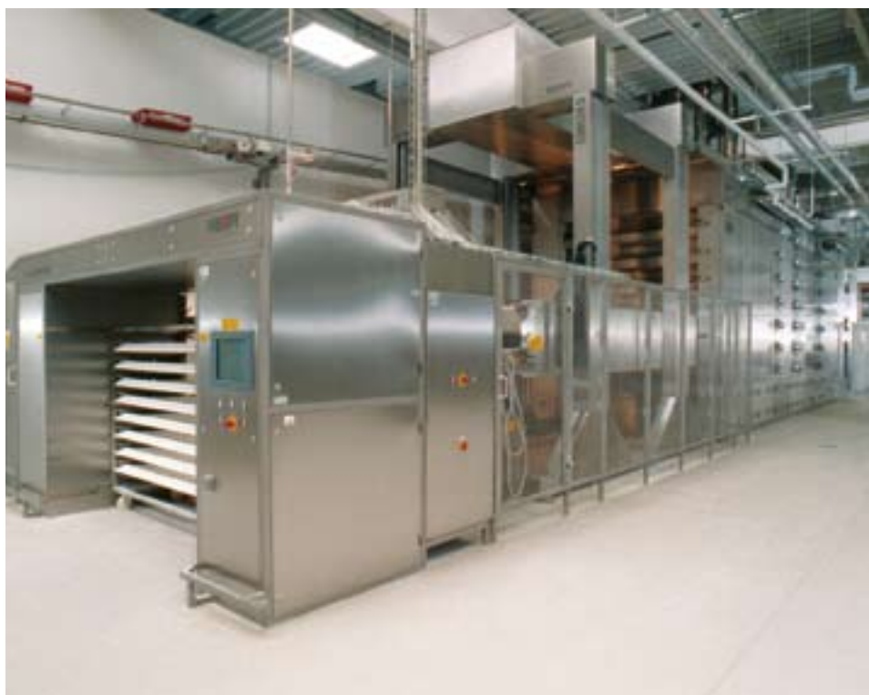
Przelotowy piec termoolejowy Impact ma możliwość zapisania nawet 199 programów wypiekowych, co pozwala otrzymywać wysokiej jakości powtarzalne produkty.
