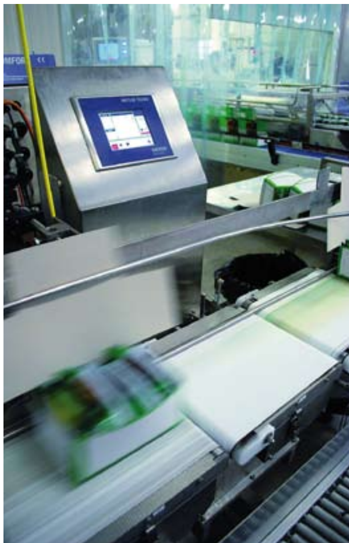
System kontroli rentgenowskiej AdvanCheK firmy METTLER TOLEDO Safeline umożliwia skuteczne wykrywanie ciał obcych, takich jak szkło, metal, kamień i tworzywa sztuczne o dużej gęstości. Fot. MT
