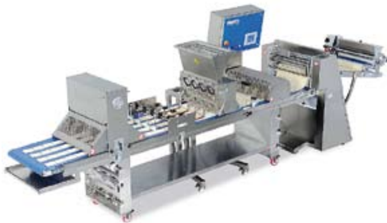
Włoski stół cukierniczy roboczy Canilino z podwójną stacją wycinająco-dekorującą może pracować z prędkością do 5 m/min. FOT. CANOL
