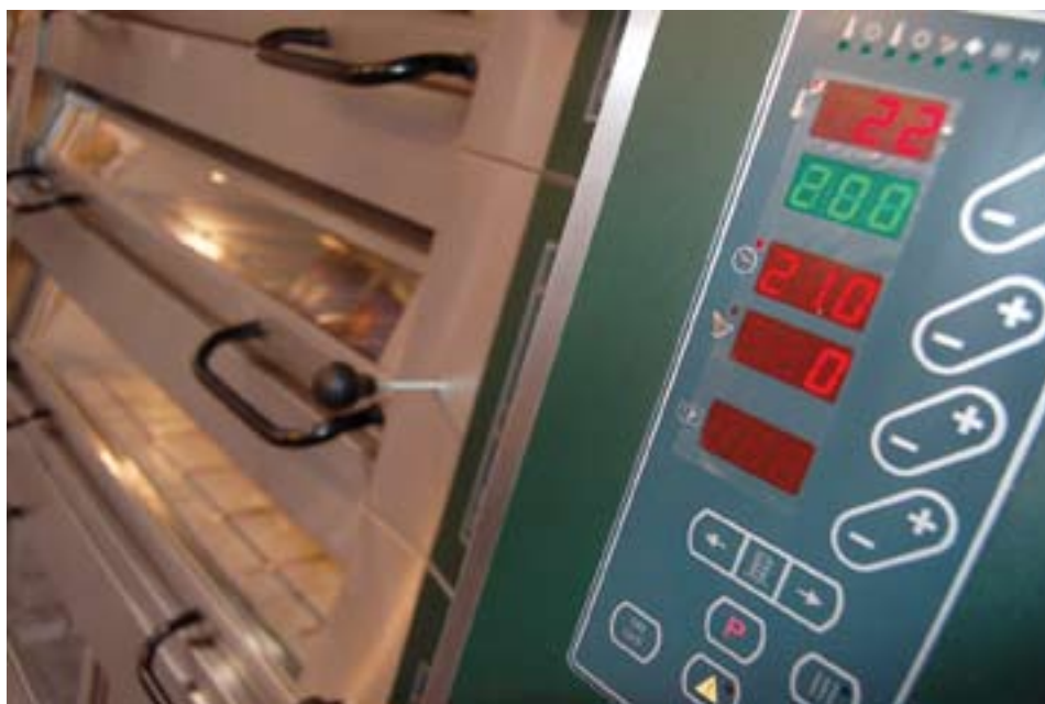
Nowoczesne panele sterujące w piecach Sveba Dahlen same obliczają średnią temperaturę grzałek górnej i dolnej, i pokazują ją na elektronicznym wyświetlaczu.
