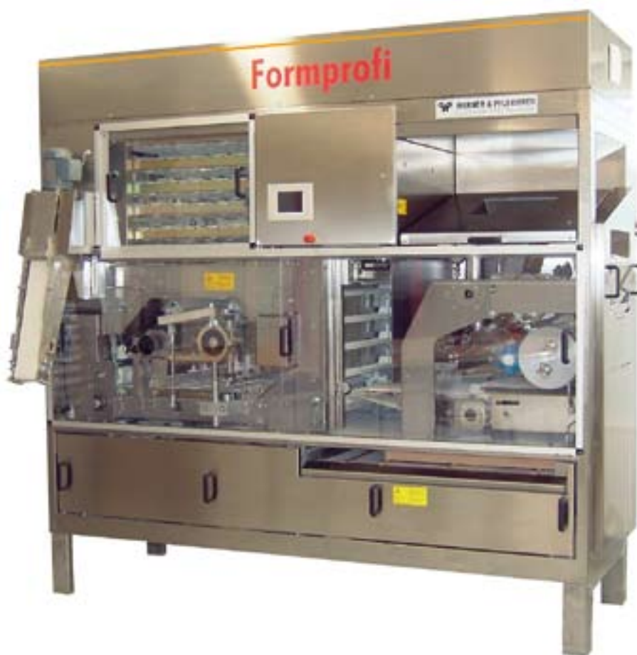
Formprofi to kompaktowa linia ze zintegrowaną dzielarką o wydajności do 4000 bułek na godzinę. FOT. MATERIAŁY PRODUCENTA
