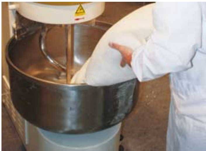
Pierwsze śladowe ilości wyciekających smarów trafiają do ciasta już podczas mieszenia, kolejne w trakcie dzielenia i zaokrąglania kęsów. Fot. B&S
