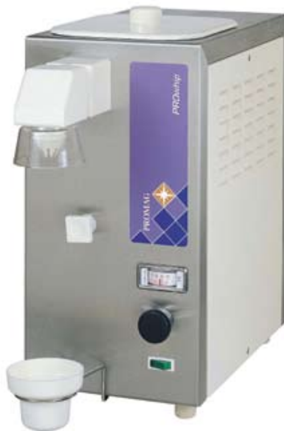
W automacie Prowhip pompa zasysa powietrze i śmietanę ze zbiornika, które przechodzą przez metalową rurkę ze specjalistycznymi wgłębieniami. W ten sposób śmietana jest napowietrzana aż do uzyskania odpowiedniej puszystości. FOT. PROMAG
