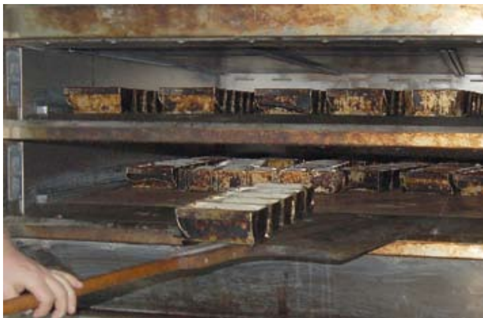
Niechlujny wygląd zewnętrzny pieca wystawionego do sprzedaży może świadczyć m.in. o jego niewłaściwej eksploatacji i braku okresowych konserwacji. Fot. B&S
