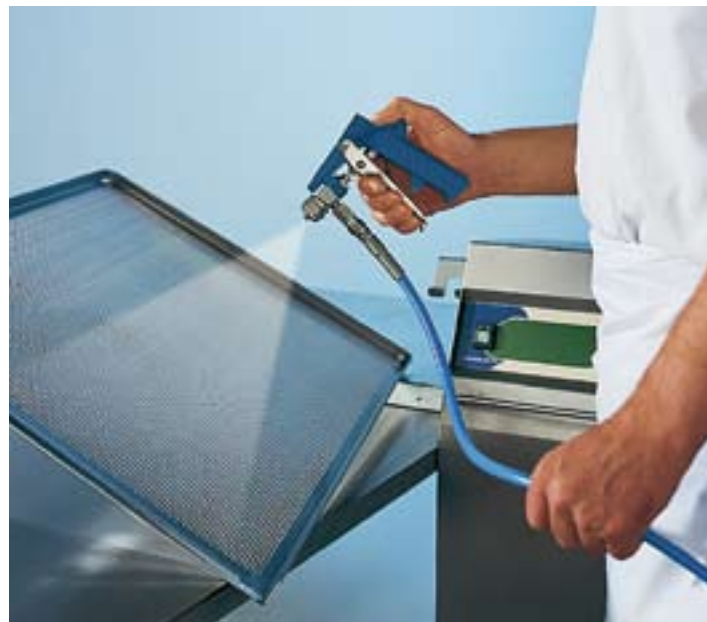
Większość preparatów antyadhezyjnych można nanosić na blachy i formy piekarnicze różnymi metodami - również za pomocą specjalistycznych pistoletów natryskowych. FOT. UNIFERM
