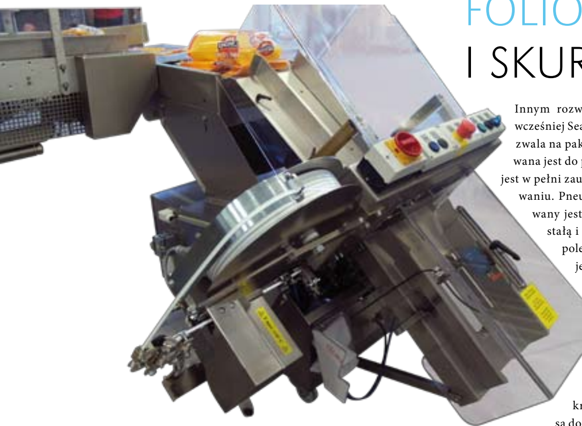
Automatyczne linie do krojenia i pakowania pieczywa niemieckiej firmy GHD Hartmann mogą być wyposażone między innymi w klipsiarki EC 130 o wydajności do 40 zamknięć na minutę. FOT. GHD HARTMANN
