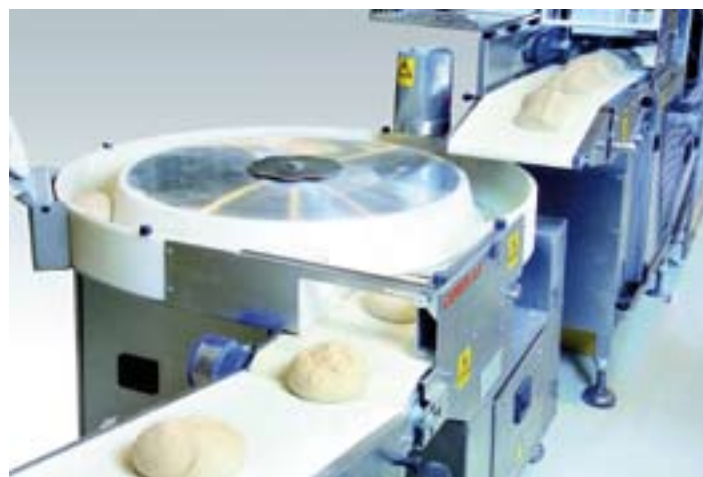
Ceres 2.0 pracuje przy produkcji chleba w wielu piekarniach rzemieślniczych. Od kilku miesięcy jego następcą jest model 2.1 - nieco łatwiejszy w czyszczeniu i z większym lejem na ciasto. FOT. KOENIG
