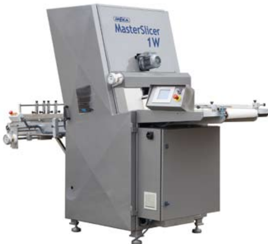
Urządzenie MasterSlicer kroi pieczywo na kromki o grubości 11 mm, ale fiński producent może dostosować krajalnicę do innych grubości. FOT. IPEKA
