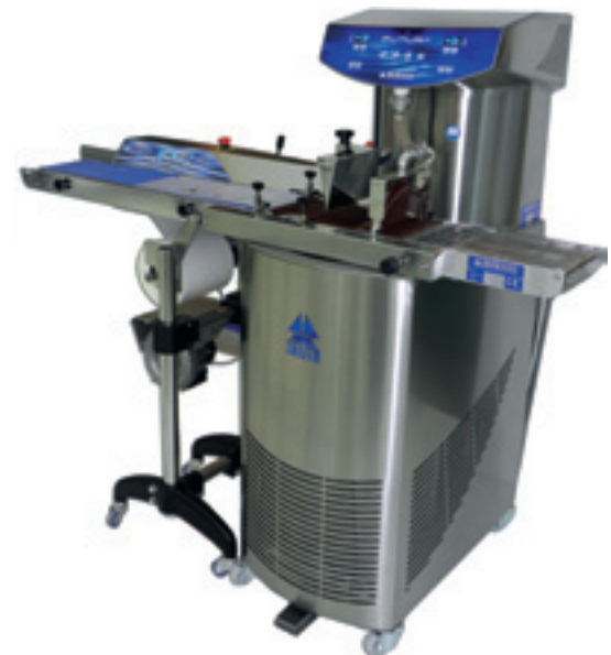
SELMI FUTURA wyposażona jest dodatkowo w blat do oblewania czekoladą. W standardowym wyposażeniu jest stół wibracyjny. Ta temperówka jest w stanie zatemperować 35 kg czekolady w 7 min
